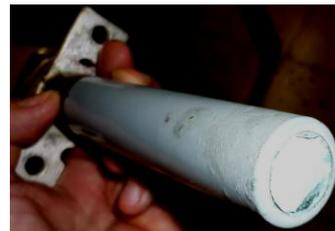
**Bild 8** Beschädigungen durch Teilentladungen an einer Löschkammer
