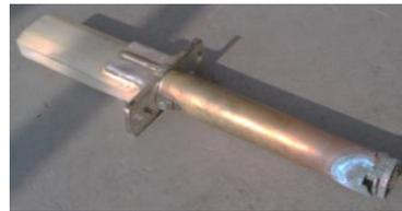
**Bild 7** Teilentladungsbehaftete Löschkammer in ausgebautem Zustand
